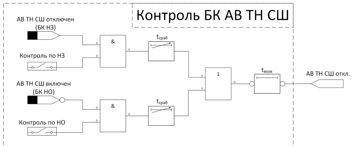
Рис. АПС. 14. Схема контроля блок-контактов автоматического выключателя ТН на СШ. (Аналогичная логика работы для ТН на КЛ)
