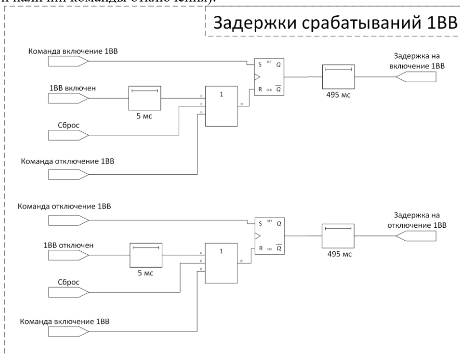
Рис. ЦУ. 3. Схема работы блока «Задержки срабатывания 1ВВ» (Аналогично осуществляется для остальных выключателей)
