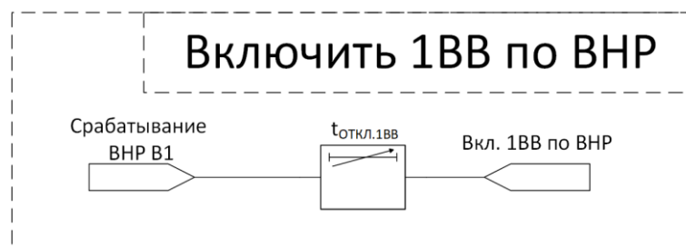
Рис. ВНР. 9. Схема работы блока «Включить 1ВВ по ВНР». (Аналогично осуществляется работа для 2ВВ)
