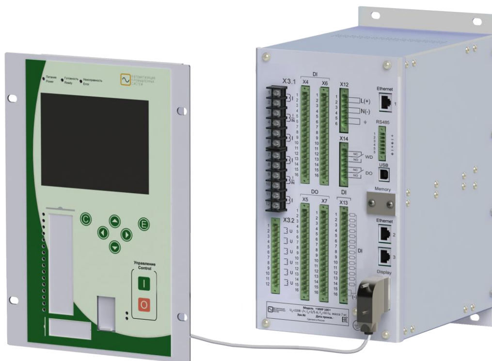
Рис. П2.23. Исполнение терминала «МИР 100» с выносным дисплеем
