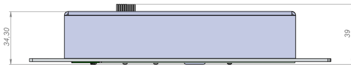
Рис. П2.3. Чертеж верхней части выносного дисплея
